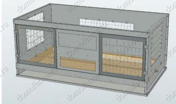
**6-й этап:** На последнем этапе устанавливается поддоны, крышка и монтируется система поения. Кормушка для сена может устанавливаться как на дверцах, так и на боковых стенках.
